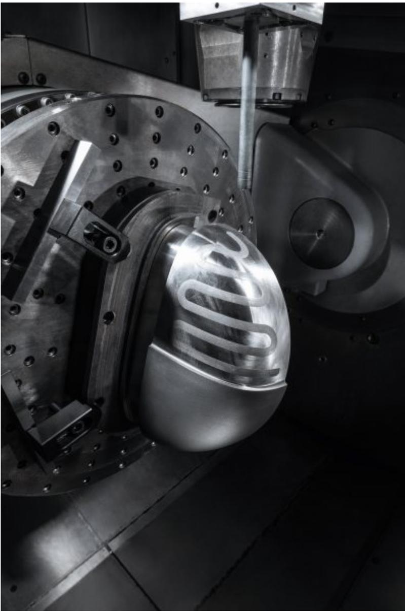
Nachdem die Kühlkanäle mit einem wasserlöslichen Metallpulver gefüllt sind, erfolgt der nächste Metallpulverauftrag (Bild: Hermle).
