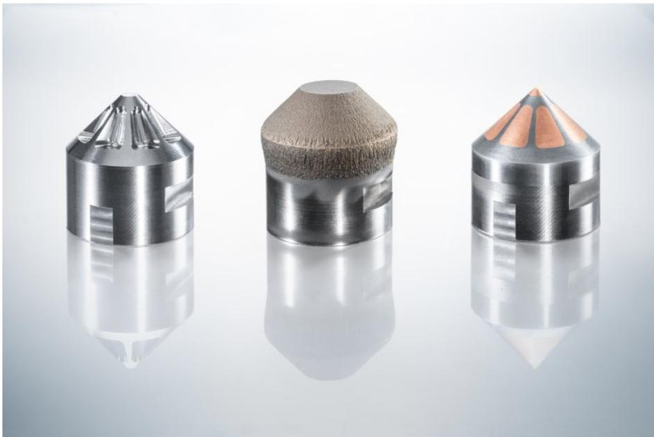
Der Vorteil hybrider Fertigung: Nach dem Ausfräsen der Taschen wird Kupferpulver aufgetragen. Im Anschluss wird überflüssiges Material spanend abgetragen (Bild: Hermle).
