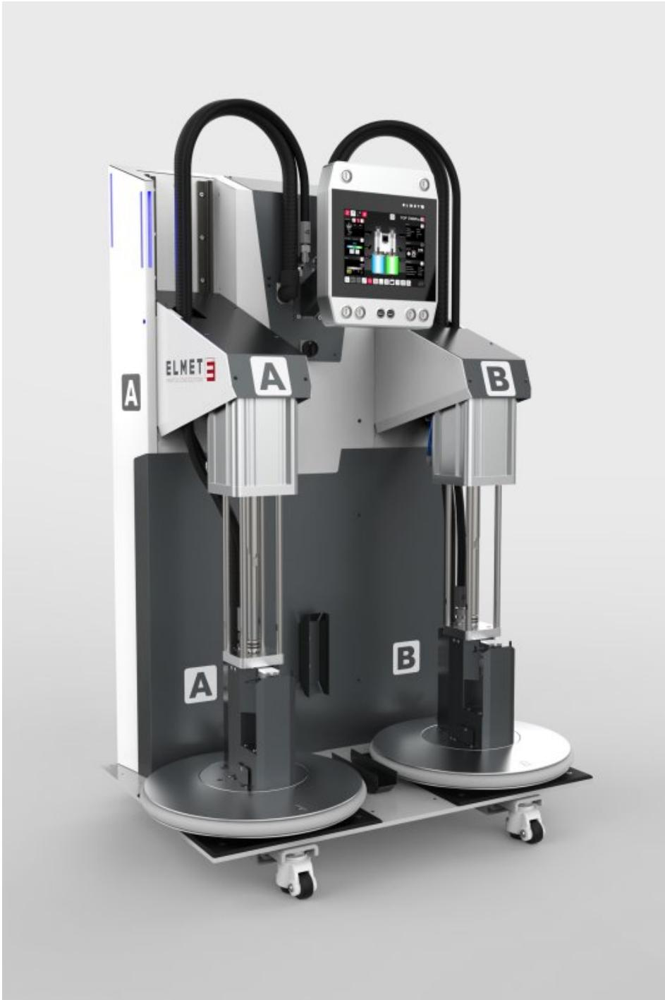
Das neue LSR-Dosiersystem bietet verbesserte Funktionalität, Prozesssicherheit und höheren Bedienkomfort (Bild: Elmet).
