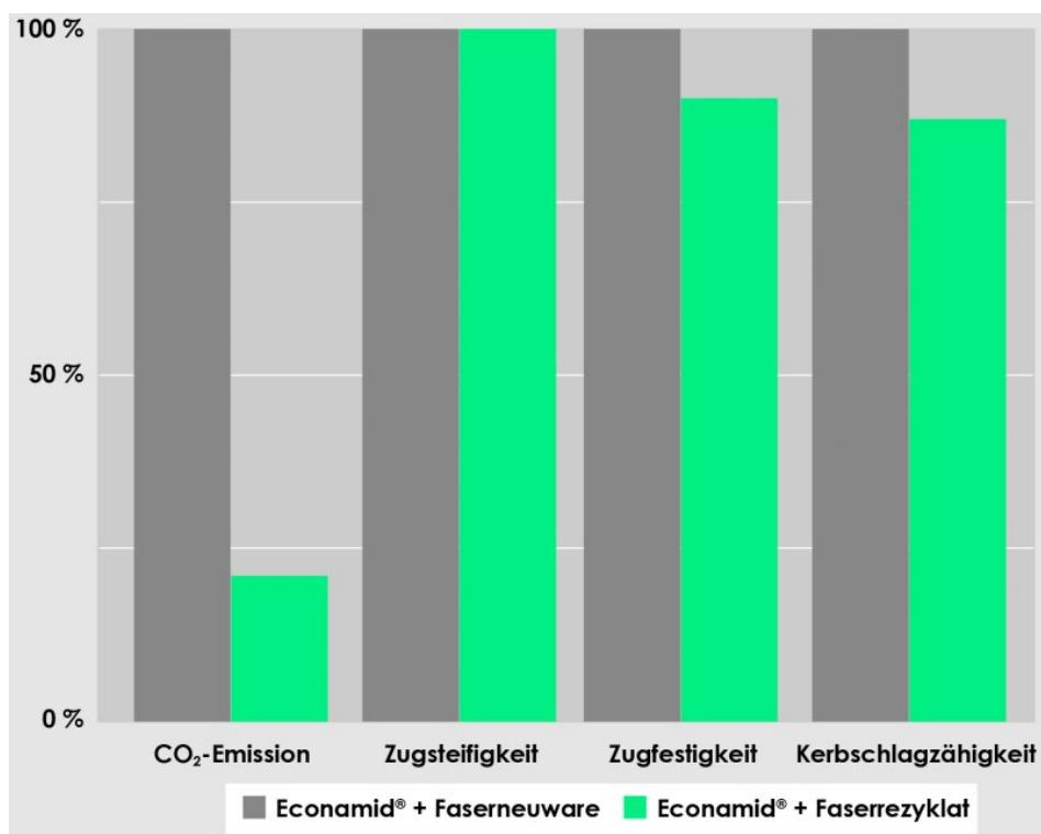
Dank des Einsatzes rezyklierter Kohlenstofffasern hat das carbonfaserverstärkte Polyamid einen geringeren CO<sub>2</sub>-Fußabdruck bei annähernd gleichen mechanischen Eigenschaften (Grafik: Ultrapolymers).
