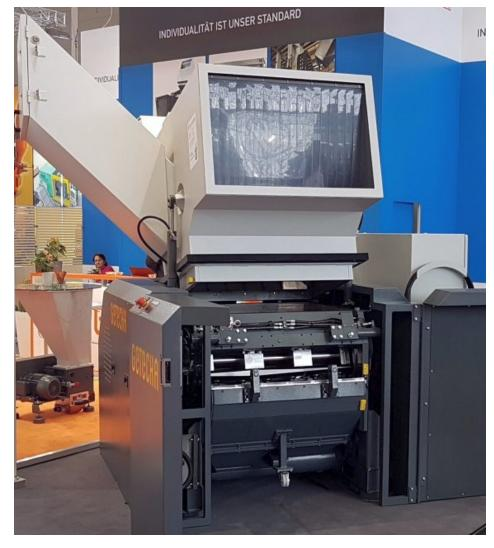
Die Trichtermühle kommt in der Kunststoffverarbeitung vorrangig als zentrale Zerkleinerungsstation zum Einsatz (Bild: Getecha).
