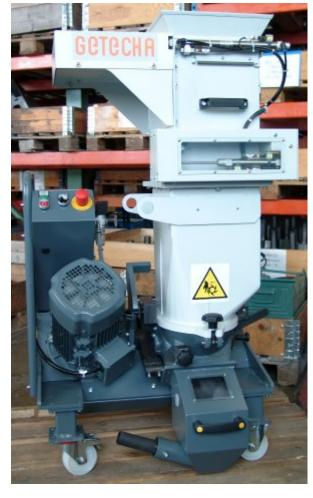
Die Sauberraummühle ist für den Einsatz in kunststofftechnischen Produktionslinien mit erhöhten Anforderungen an Hygiene und Sauberkeit ausgelegt (Bild: Getecha).
