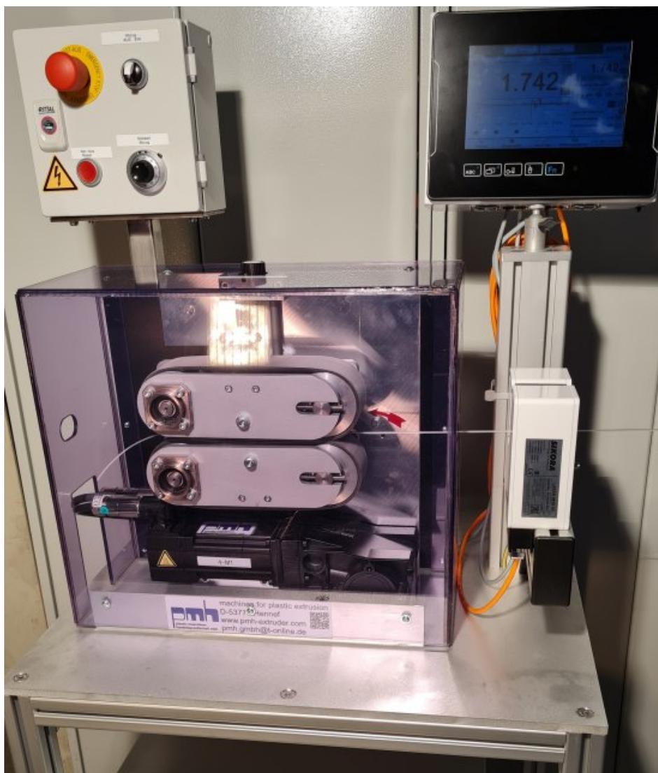
Die neue Bandabzugsmaschine mit zwei gummierten Bändern leistet ausreichend Zugkraft für kleine Profile (Bild: PMH).
