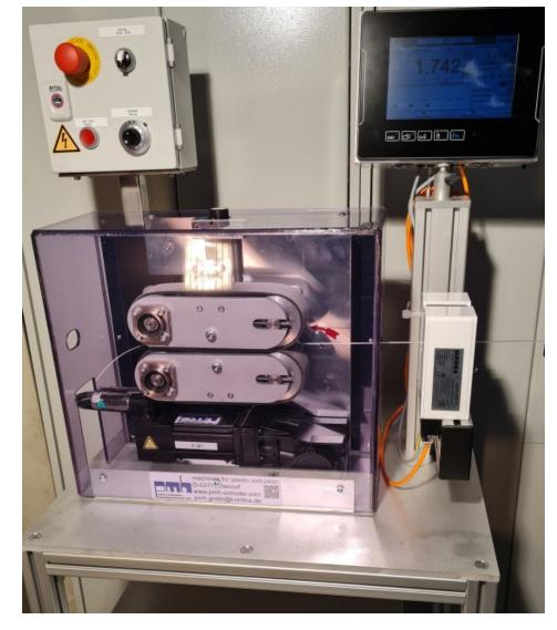
Die neue Bandabzugsmaschine mit zwei gummierten Bändern leistet ausreichend Zugkraft für kleine Profile (Bild: PMH).
