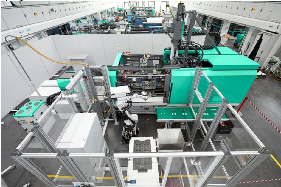
Der hybride Spritzgießmaschine mit kompaktem Würfelwerkzeug erreicht eine hohe Ausbringungsmenge (Bild: Arburg).
