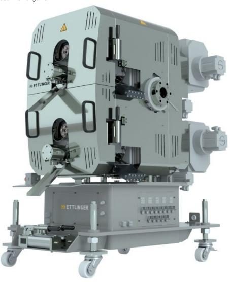
Die Hochleistungs-Schmelzefilter erreichen Durchsatzleistungen von 150 bis zu 4000 kg/h (Bild: Ettlinger).
