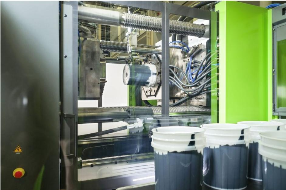
Zur Demonstration des Koinjektionsverfahrens wird ein transparentes Hautmaterial aus Neuware mit einem schwarzen Rezyklat kombiniert (Bild: Engel).
