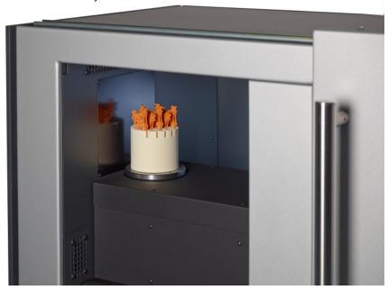
Industrielle Computertomografie ermöglicht die Messung von mehreren Werkstücken in einem Arbeitsgang (Bild: Werth).
