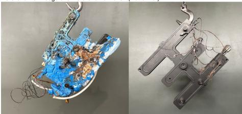
Dank der thermischen Entfernung von Kunststoffresten von Heißkanalsystemen sind diese wieder einsatzbereit (Bild: Schwing).
