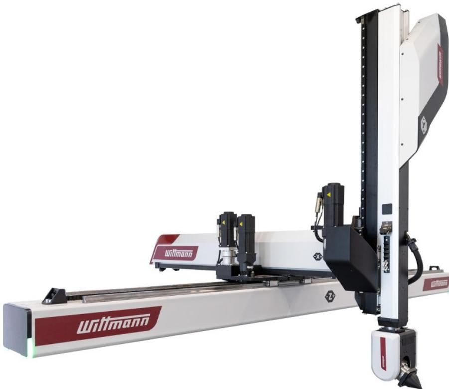
Entnahmeroboter mit an der Vertikalachse montierter Servo-Rotationsachse (Bild: Wittmann Battenfeld).
