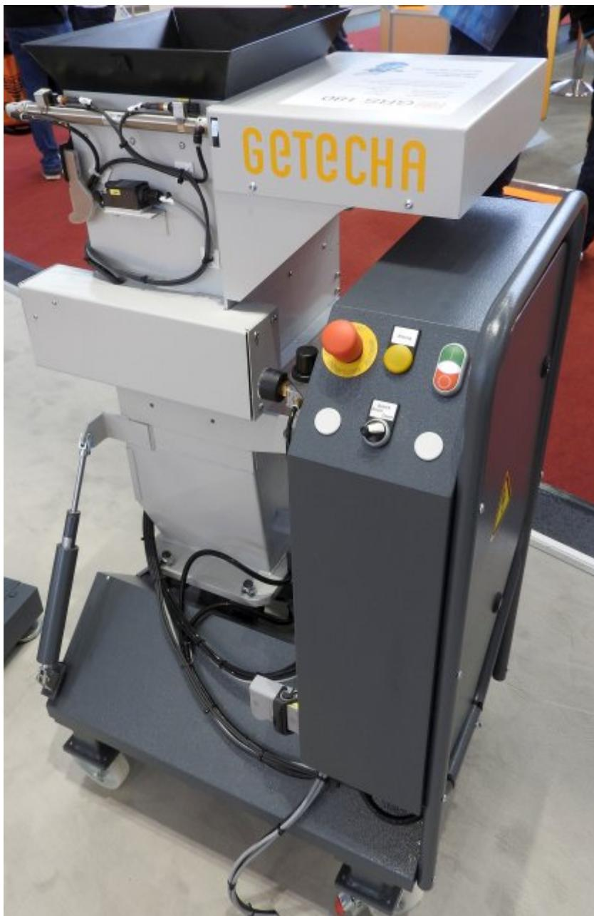
Die Sauberraum-Beistellmühle ist in platzsparender Niedrigbauweise ausgeführt (Bild: Getecha).
