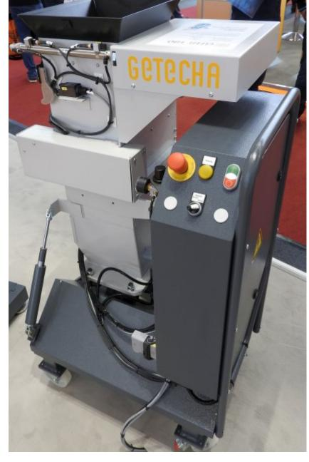
Die Sauberraum-Beistellmühle ist in platzsparender Niedrigbauweise ausgeführt (Bild: Getecha).
