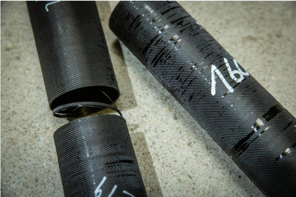
Der zerstörte Probekörper nach einem Belastungstest. Die mathematische Vorhersage konnte den eintretenden Schaden gut vorhersagen (Bild: Heike Fischer/TH Köln).
