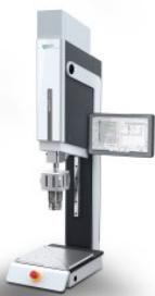
Die neue Ultraschallschweißmaschine wurde für einen besonders hohen Kraftbereich entwickelt (Bild: MS Ultraschall Technologie).
