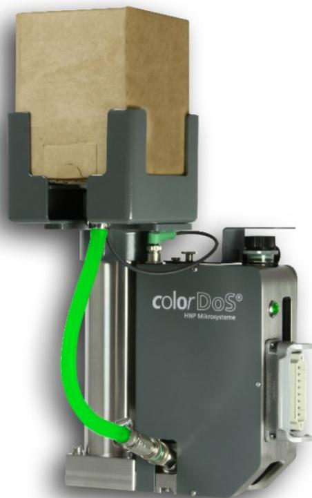
Das kompakte Dosiersystem ist für die Umstellung von Masterbatch auf den Einsatz von Flüssigfarben geeignet (Bild: HNP).
