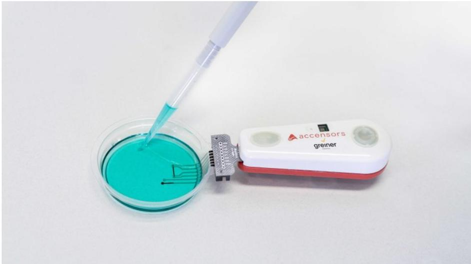
Die gedruckte Sensorik ermöglicht das einfache Auslesen der Messwerte via Auslesegerät und App (Bild: Greiner).
