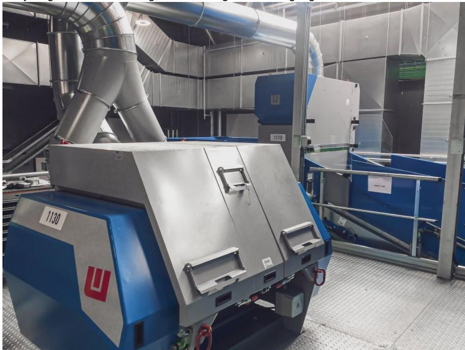
Hier wird die leichte Fraktion mittels rotierender Siebtrommel dem Luftstrom entnommen
