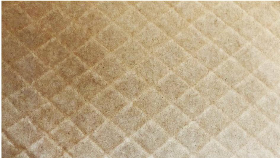
Das neue Hotmelt-Tape verfügt über eine geometrisch präzise, gitterförmige Faserverstärkung (Bild: Schümann).
