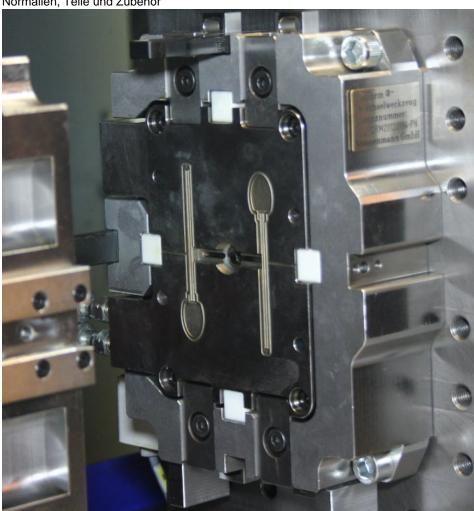
Spritzgießwerkzeug mit Keramikelementen zur thermischen Trennung und
