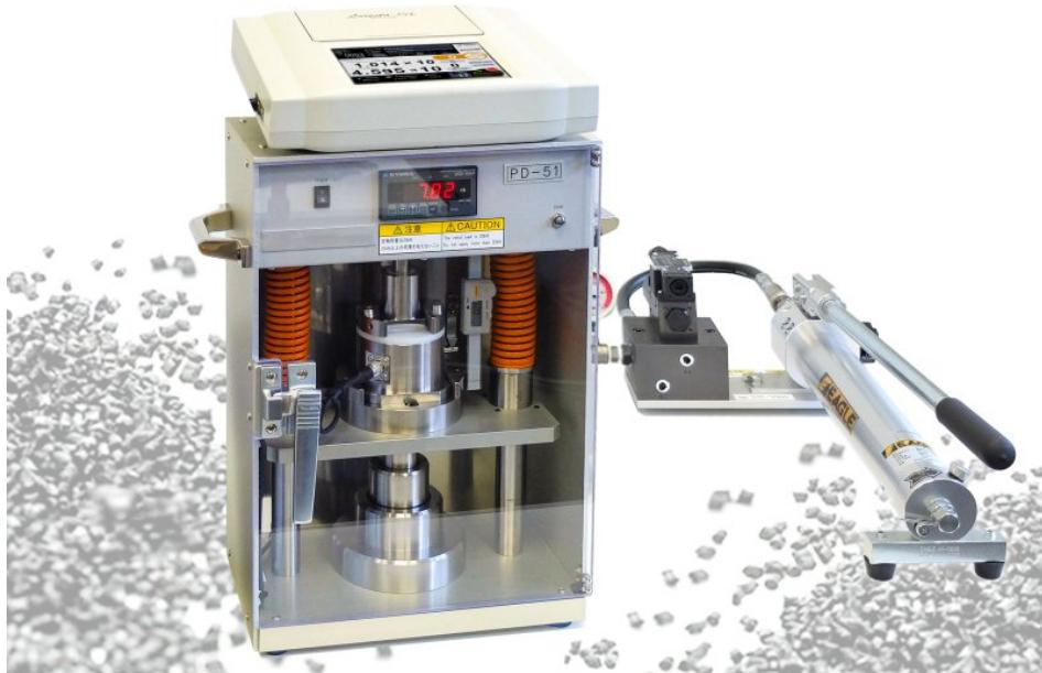
Das Pulvermesssystem bestimmt die physikalischen Eigenschaften von Pulver über den spezifischen Widerstand (Bild: N&H Technology).
