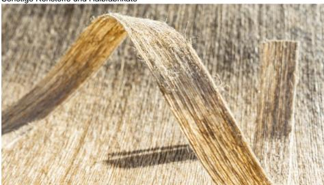
Die naturfaserbasierten Thermoplasthalbzeuge eignen sich z. B. für dünne und leichte Lärmschutzwände (Bild: Büfa).
