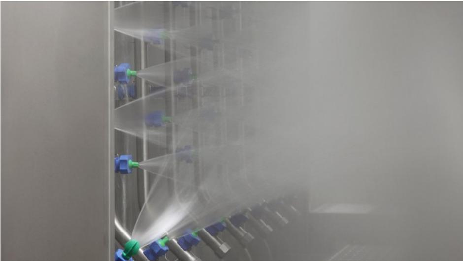
Der neue Spritzreiniger reduziert den Energieaufwand für Powerwash-Anlagen deutlich (Bild: Zeller+Gmelin).
