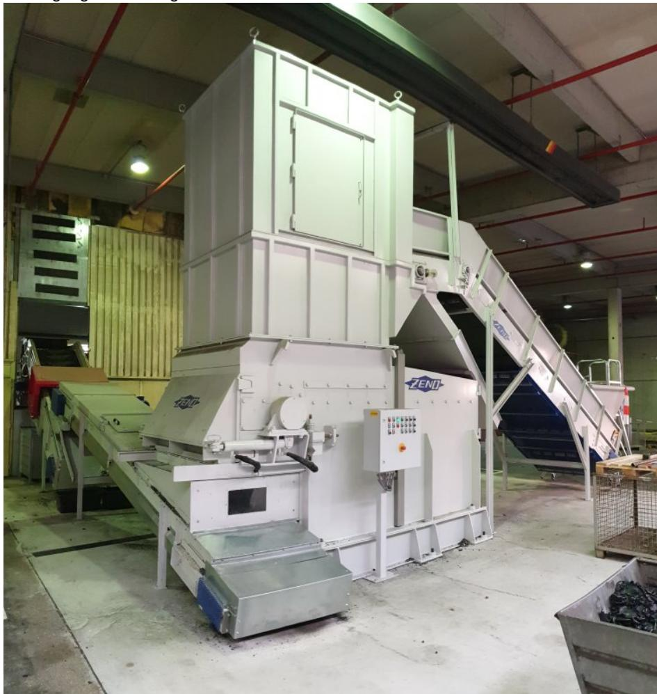
Der robuste Einwellenzerkleinerer verfügt über einen Vollstahlrotor und eine lastabhängige, hydraulische Materialzufuhr (Bild: Zeno).
