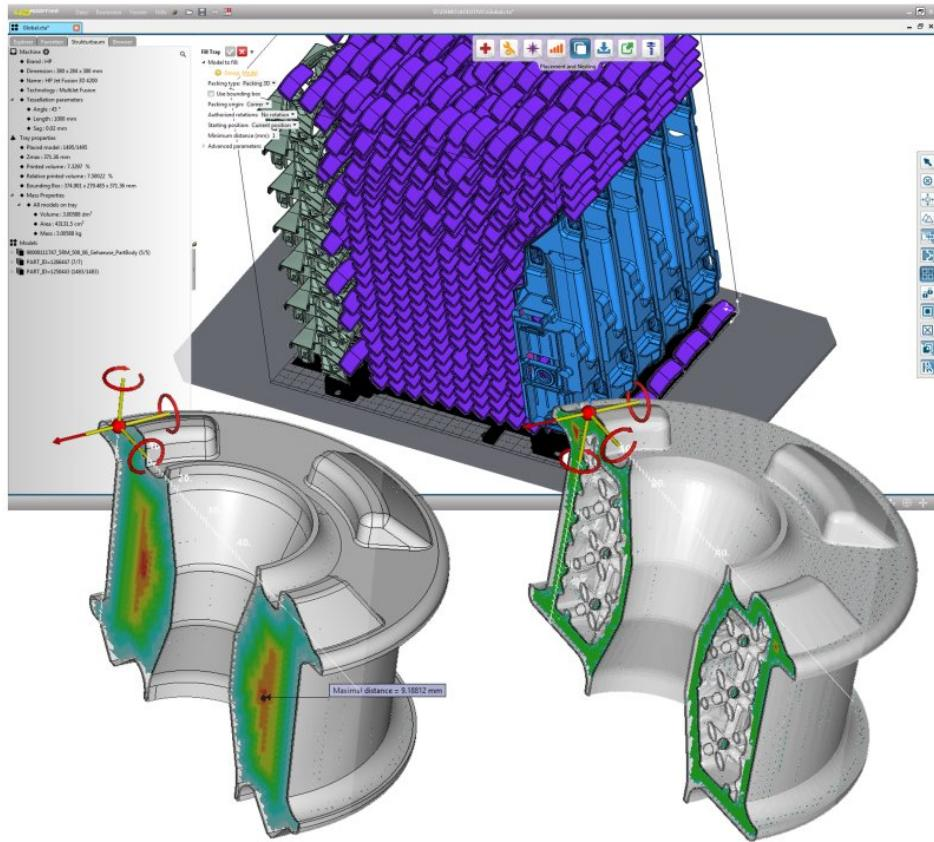
Die Nesting-Funktion der 3D-Druck-Software nutzt KI zur Optimierung der Bauteile (Bild: Core Technologie).
