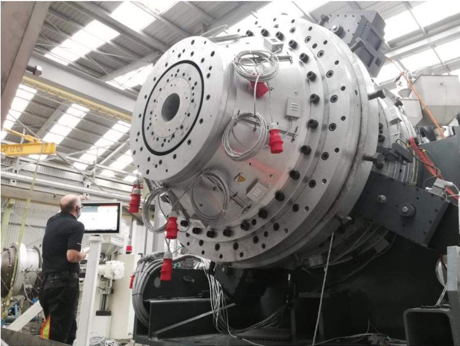
Bei der neuen Extrusionslinie stellt sich auf Knopfdruck der Rohrkopf auf eine neue Rohrdimension um (Bild: battenfeld-cincinnati).
