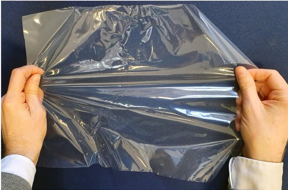
Schrumpffolie mit LDPE-Rezyklat sind nahezu identisch mit Folien aus Neuware (Bild: APK).
