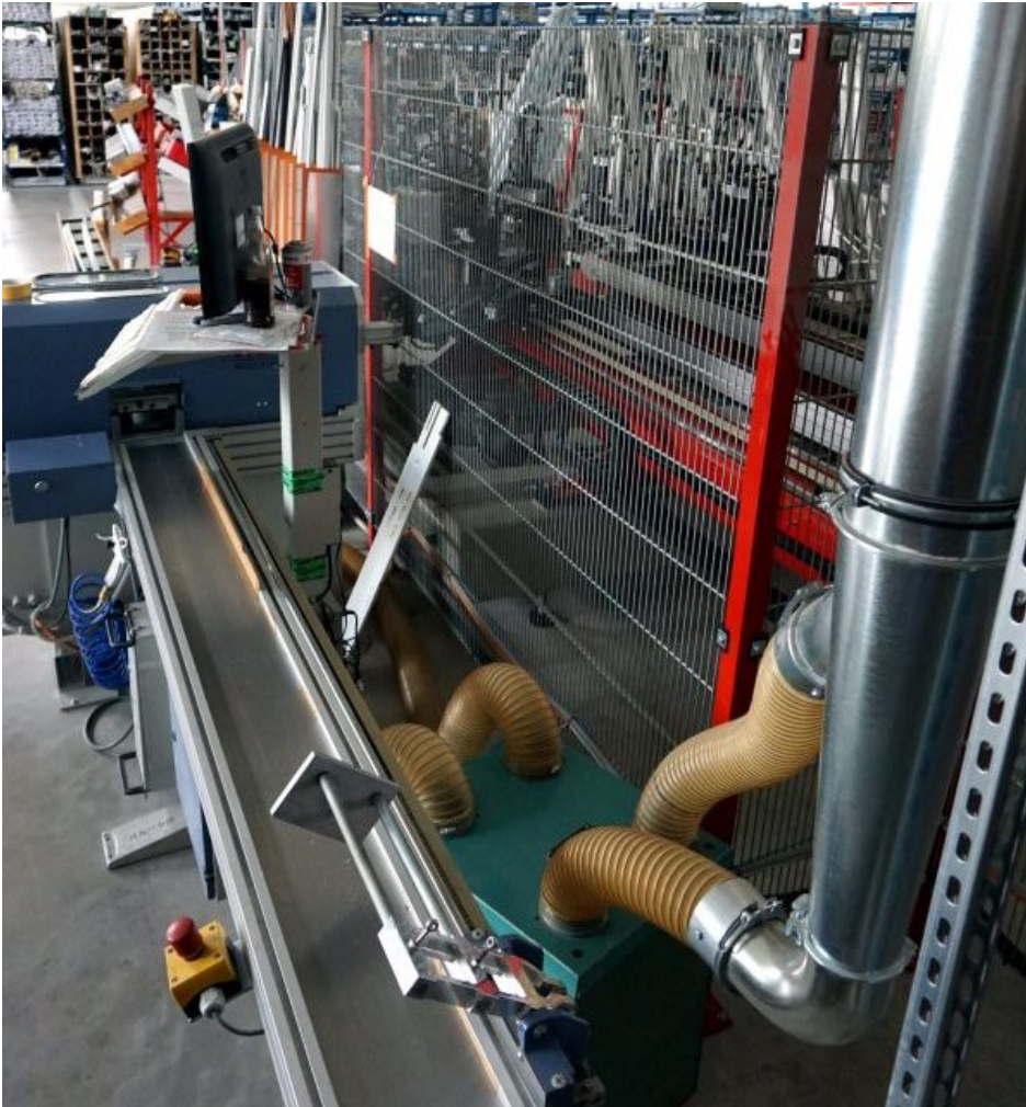
Absauganschluss einer Rotox Glasleistensäge (Bild: Nestro).
