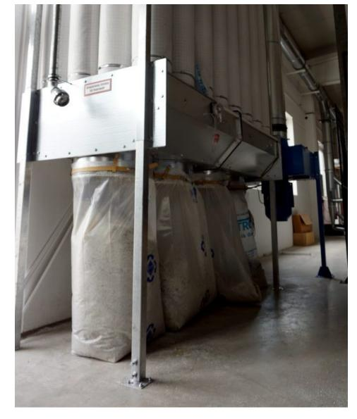
Das herausgefilterte Material wird über eine Rüttlung gleichmäßig in vier Spänefangsäcke abgeschieden (Bild: Nestro).
