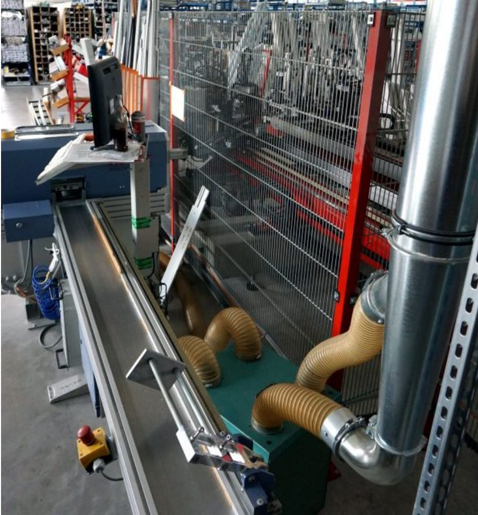
Absauganschluss einer Rotox Glasleistensäge (Bild: Nestro).
