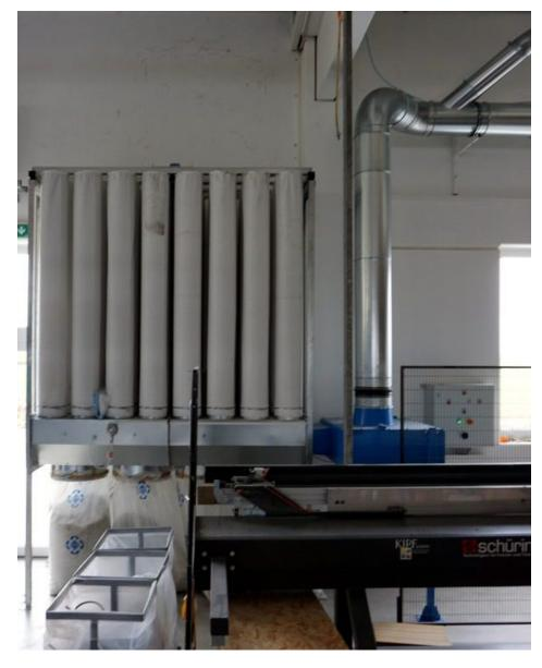
Das Absackfiltersystem mit 32 Filterschläuchen und einer Filterfläche von 46 Quadratmetern wird auch mit größeren Profilabschnitten fertig (Bild: Nestro).
