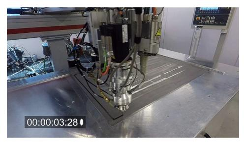
Bei großen Schaltschranktüren kommen die Vorteile der geschwindigkeitsabhängigen Dosiertechnologie zum Vorschein. Ohne geschwindigkeitsabhängige Dosierung (im Bild oben) schafft der Roboter deutlich weniger Strecke in der gleichen Zeit als mit
