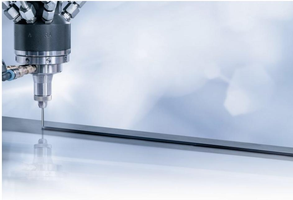
Die geschwindigkeitsabhängige Dosierung ist präzise in den Ecken und schnell auf der Geraden (Bild: Rampf).
