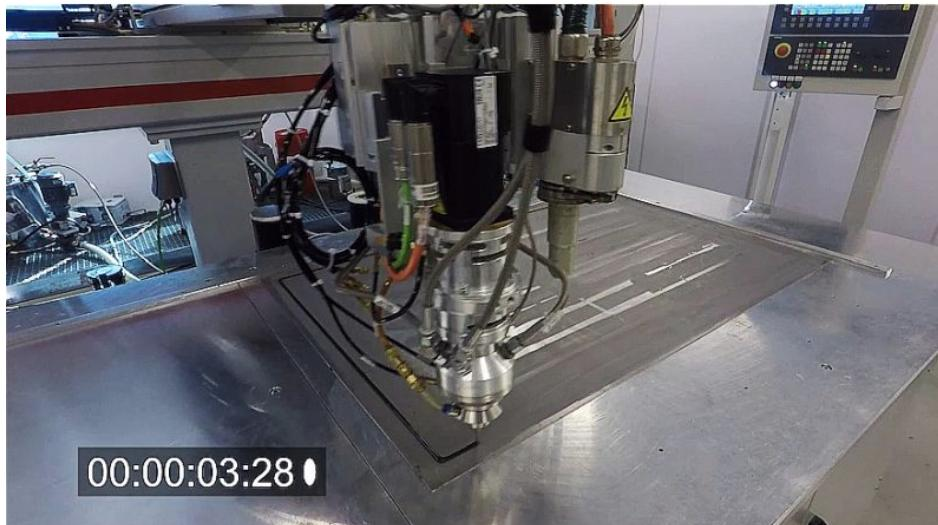
Bei großen Schaltschranktüren kommen die Vorteile der geschwindigkeitsabhängigen Dosiertechnologie zum Vorschein. Ohne geschwindigkeitsabhängige Dosierung (im Bild oben) schafft der Roboter deutlich weniger Strecke in der gleichen Zeit als mit
