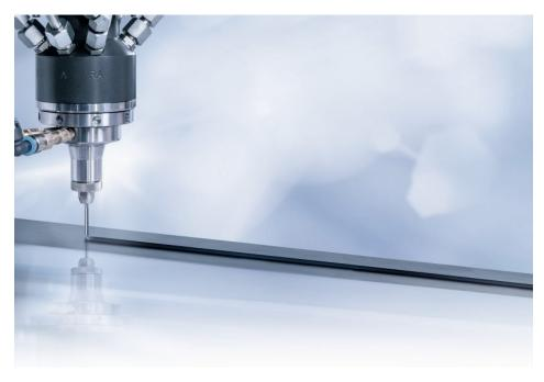
Die geschwindigkeitsabhängige Dosierung ist präzise in den Ecken und schnell auf der Geraden (Bild: Rampf).
