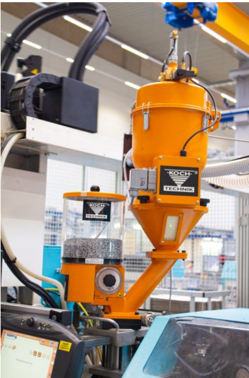
Förderabscheider und Masterbatch-Dosiereinheit auf der Spritzgussmaschine (Bild: Koch-Technik).
