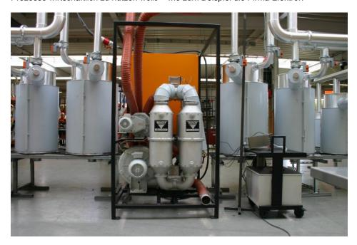
Granulattrockner mit frequenzumrichtergesteuerten Ventilatoren (Bild: Elektror airsystems).
