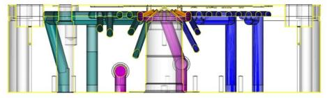
Bild 3: Schnittbild durch den betrachteten Formeinsatz (Bild: Contura MTC).
