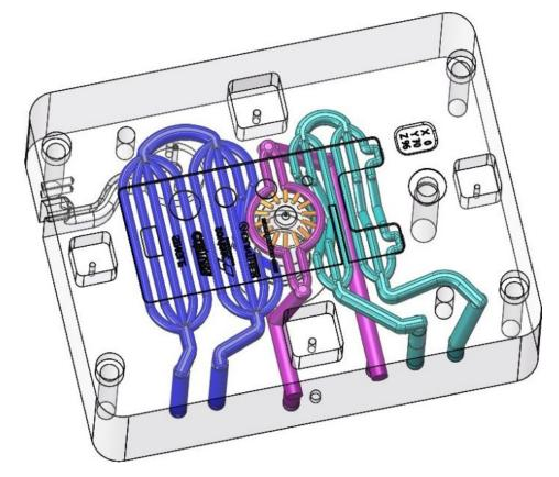
Bild 2: Temperiermittelkanallayout zum simulierten Formeinsatz (s. Bild 1) - Bild: Contura MTC.
