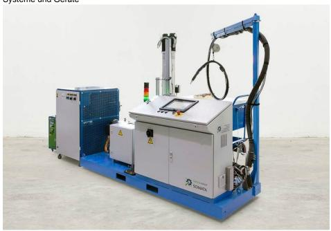
Mit der Clay-Applikationsmachine »Cama 01 « bietet Somata ein System für das Auftragen von Formenbau-Plastiline (Bild: Tartler).
