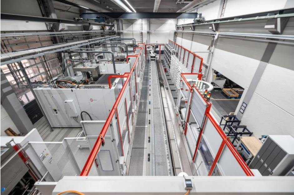
Linear verkettet: Ein Roboter bedient mehrere 5-Achs-Bearbeitungszentren und sorgt so für eine hohe Produktivität und Flexibilität (Bild: Hermle).
