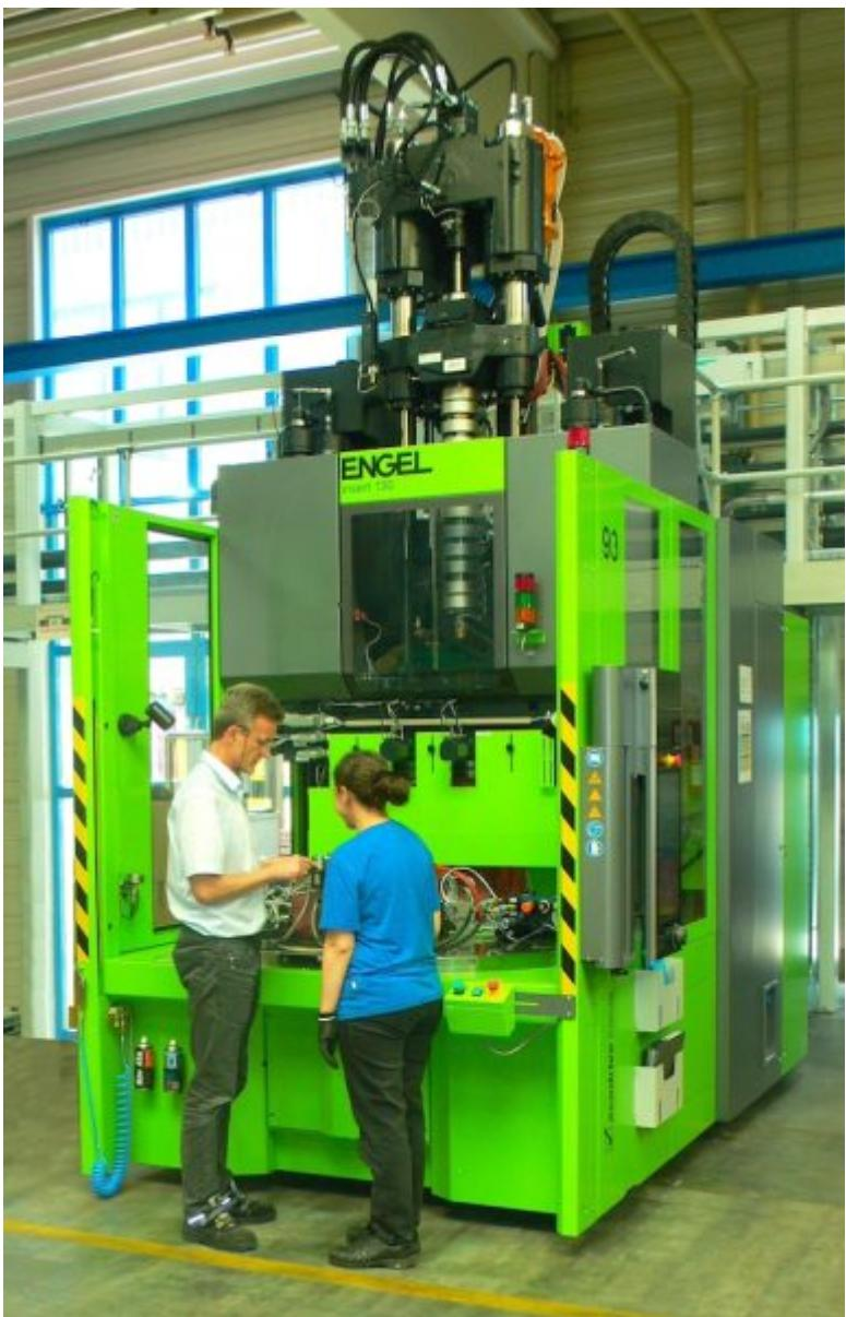
Für die Fertigung des Kontaktgehäuses wurde in eine neue Vertikalspritzgießmaschine mit Rundteller investiert (Bild: Weiss).
