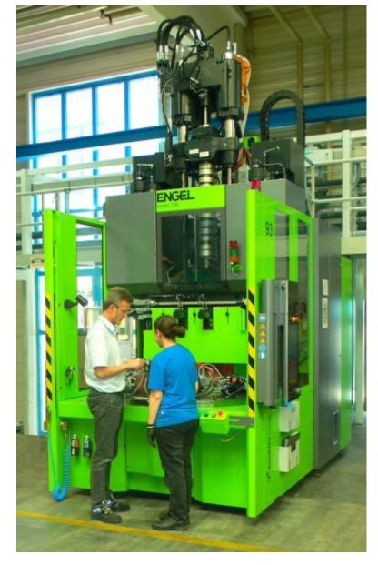
Für die Fertigung des Kontaktgehäuses wurde in eine neue Vertikalspritzgießmaschine mit Rundteller investiert (Bild: Weiss).
