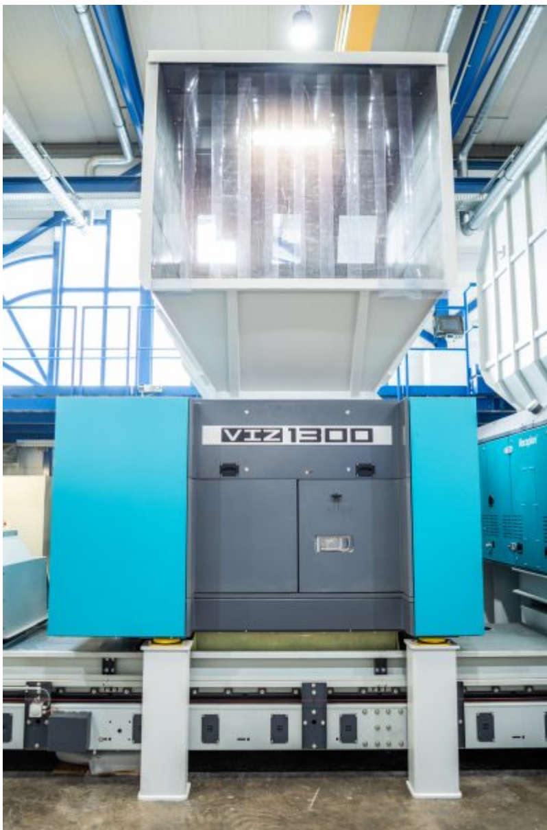
Der neue einstufige Zerkleinerer der Baureihe »VIZ« kann vielfältige Kunststoffmaterialien zerkleinern (Bild: Vecoplan).
