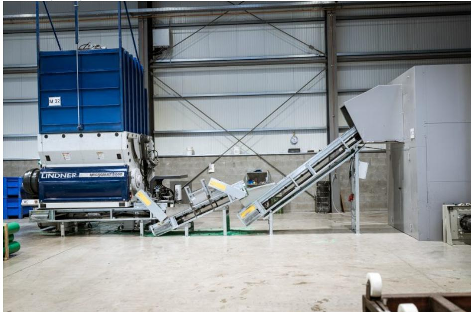
Dank des Zerkleinerers mit neuem Schnittsystem konnte der Durchsatz weiter gesteigert werden (Bild: Lindner-Recyclingtech).
