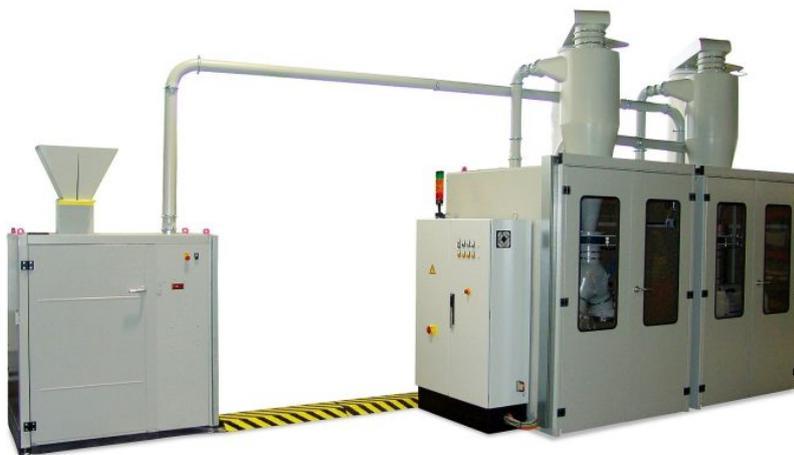
In dieser Zerkleinerungslinie sind die Folienschneider mit den Trichtermühlen kombiniert (Bild: Getecha).
