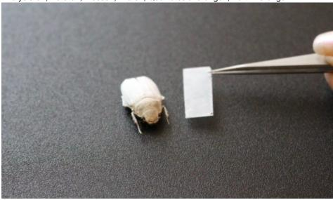
Nach dem Vorbild der Natur erzeugt ein nanostrukturierter Polymerfilm eine strahlend weiße Beschichtung (Bild: Julia Syurik, KIT).
