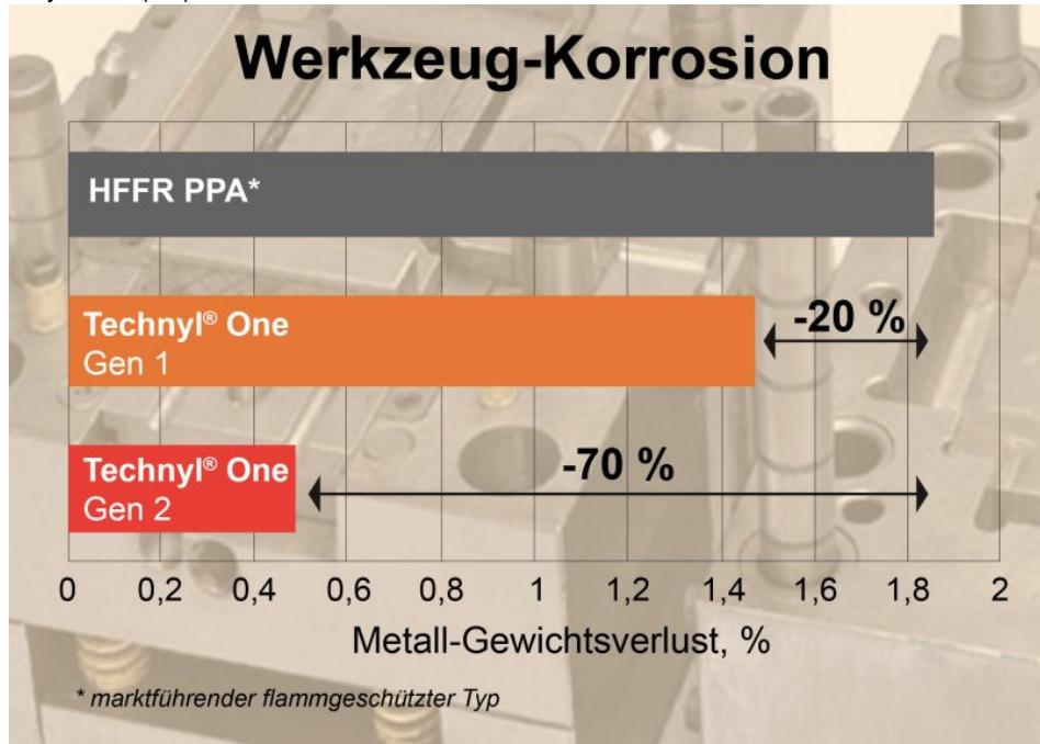
Die HFFR-Polyamide der zweiten Generation ermöglichen sehr lange Werkzeugstandzeiten (Bild: Domo/Ultrapolymers).
