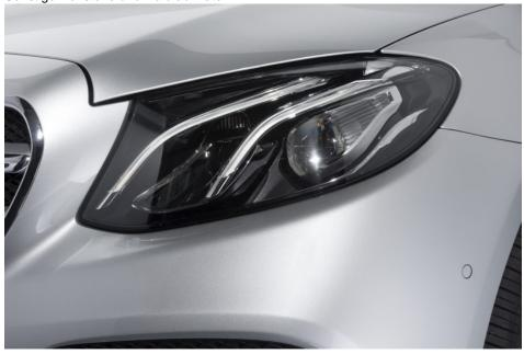
Diese Scheinwerferabdeckung eines Mercedes E besteht beispielsweise aus transparentem Polycarbonat (Bild: Covestro).
