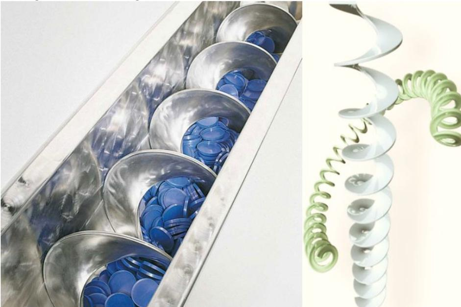
Achsenlose Förderspiralen in biegsamer oder starrer Ausfertigung fördern Granulat und fertige Teile (Bild: Wildfellner).
