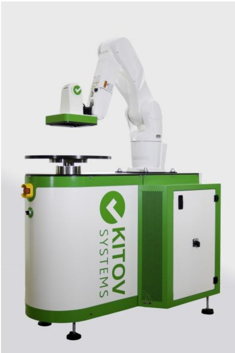
Das Inspektionssystem nutzt künstliche Intelligenz und vermeidet so aufwendige manuelle Nachprüfungen (Bild: Atecare Service).
