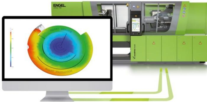
Simulationsdaten können direkt in die Maschine und Messdatensätze aus der Maschinensteuerung übertragen werden (Bild: Engel).
