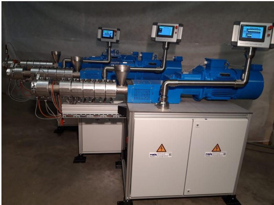
Die 25-mm-Compounder eignen sich z. B. zur Herstellung von Kleinprofilen und Filament für den 3D-Druck (Bild: PMH).
