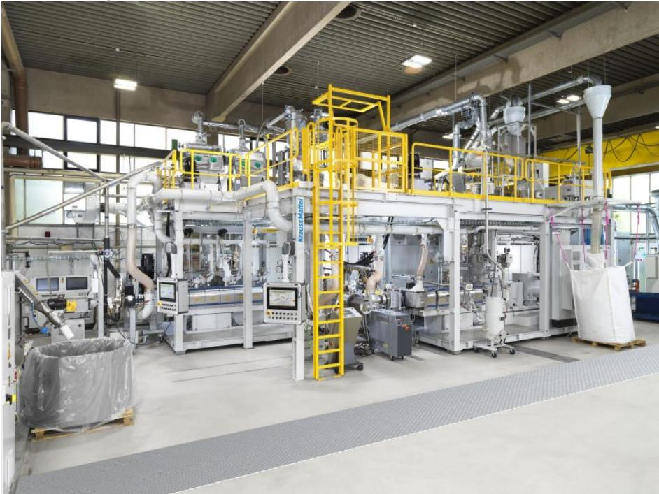
Die Recompoundieranlage mit zwei Zweischnellenextrudern ist für eine Leistung von rund 2000 kg/h ausgelegt (Bild: KraussMaffei Extrusion).
