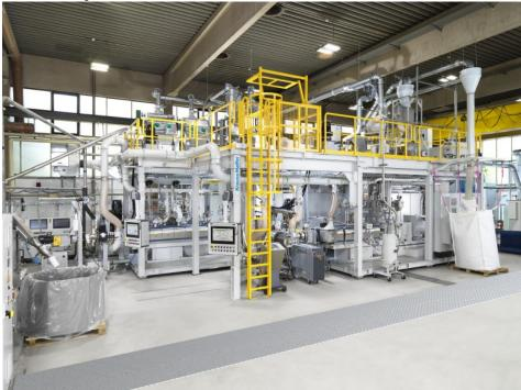
Die Recompoundieranlage mit zwei Zweischneckenextrudern ist für eine Leistung von rund 2000 kg/h ausgelegt (Bild: KraussMaffei Extrusion).
