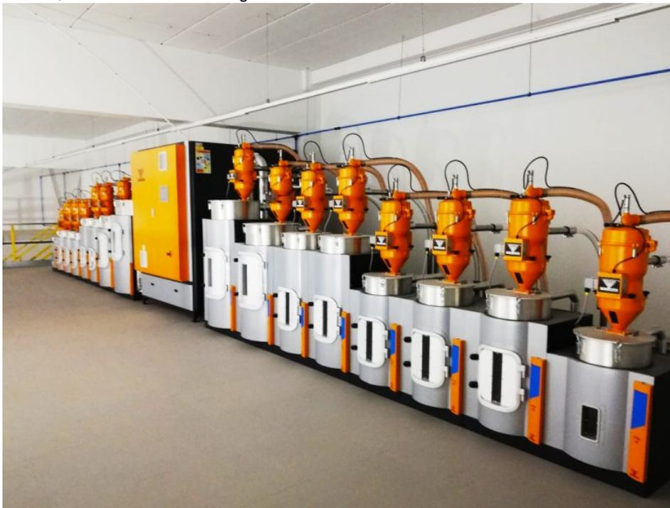
Fitnessgerätehersteller Tacx setzt auf einen neuen Trockner mit 16 Trocknungsbehältern (Bild: Koch Maschinentechnik).
