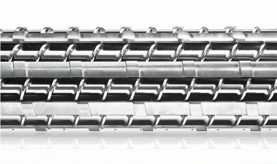
Das Multischneckenelement vergrößert die für die Entgasung zur Verfügung stehende Schmelzeoberfläche (Bild: Gneuß).
