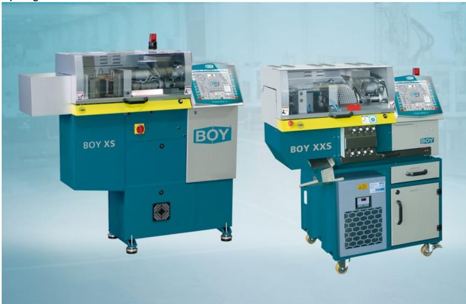
Die kompakten Spritzgießautomaten für den Mikrospritzguss bieten jetzt ein erhöhtes Plastifizierungsvolumen (Bild: Dr. Boy).
