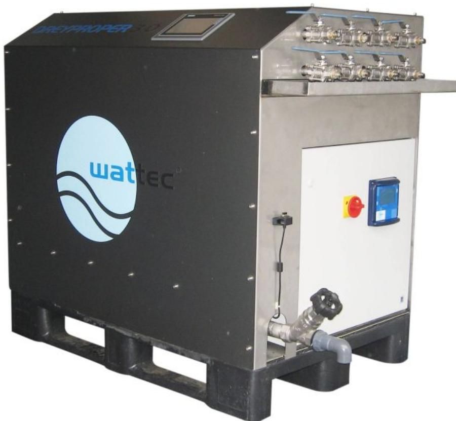
Das Reinigungsgerät »Dreyproper« entfernt die Ablagerungen in Kühlkanälen von Spritzgusswerkzeugen vollautomatisch (Bild: Wattec).
