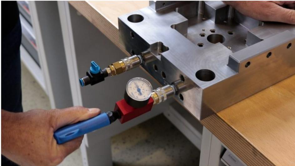
Das Gerät zur Prüfung der Werkzeug-Dichtigkeit ist besonders einfach in der Handhabung (Bild: Nonnenmann).
